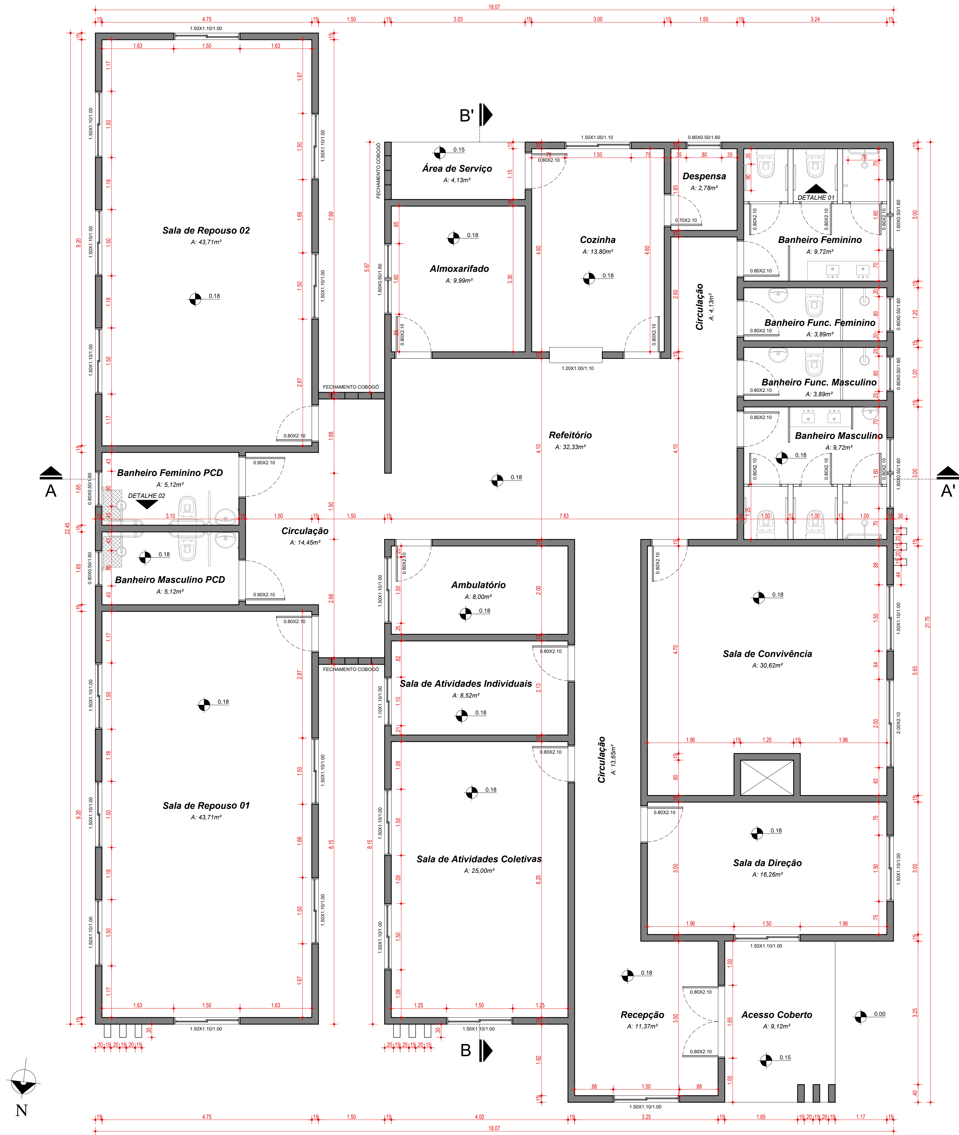
Planta Baixa - Centro Dia Doutor Ricardo/RS Área: 361,00 m² Escala: 1/50
