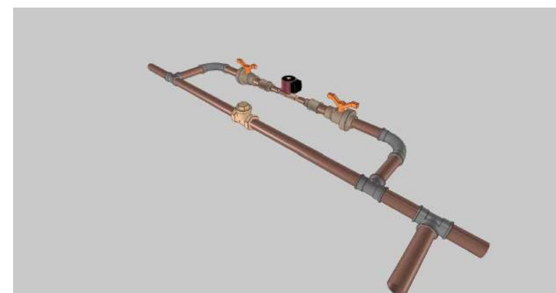
DETALHE - Pressurizador Sem escala
