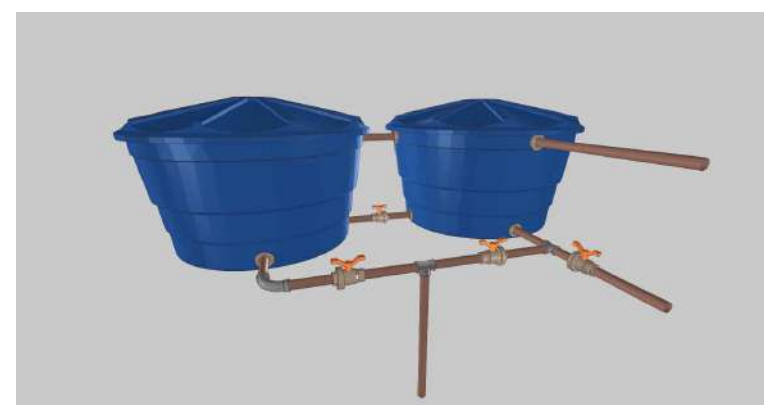
DETALHE - Estravosor e expurgo Sem escala
